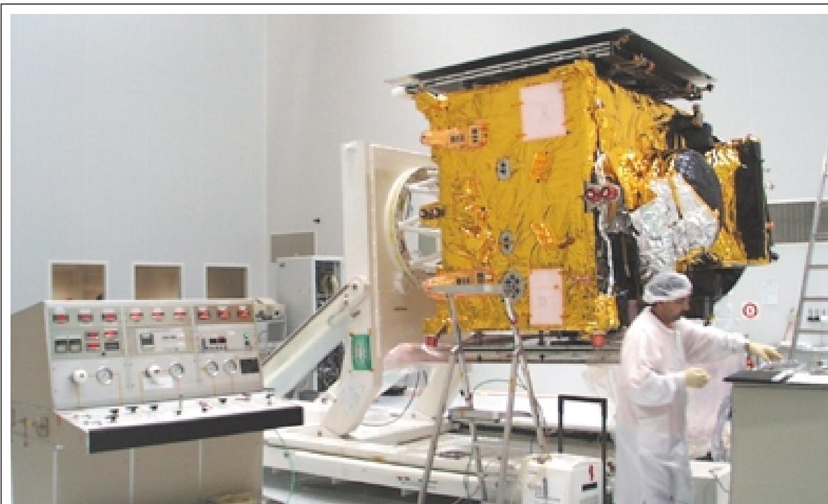
*Test d'autonomie d'un satellite.*
